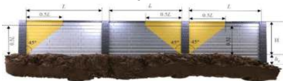
شکل ۴-۸ محاسبه سطح بارگیر کلاف‌های قائم
