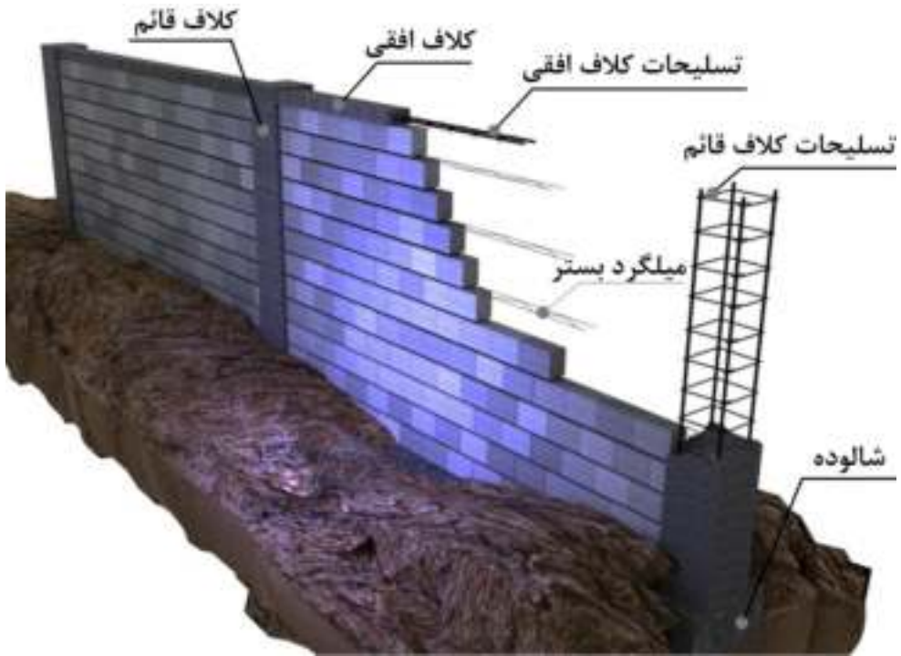
شکل ۱-۲ قسمت‌های اصلی دیوارهای محوطه بنایی
