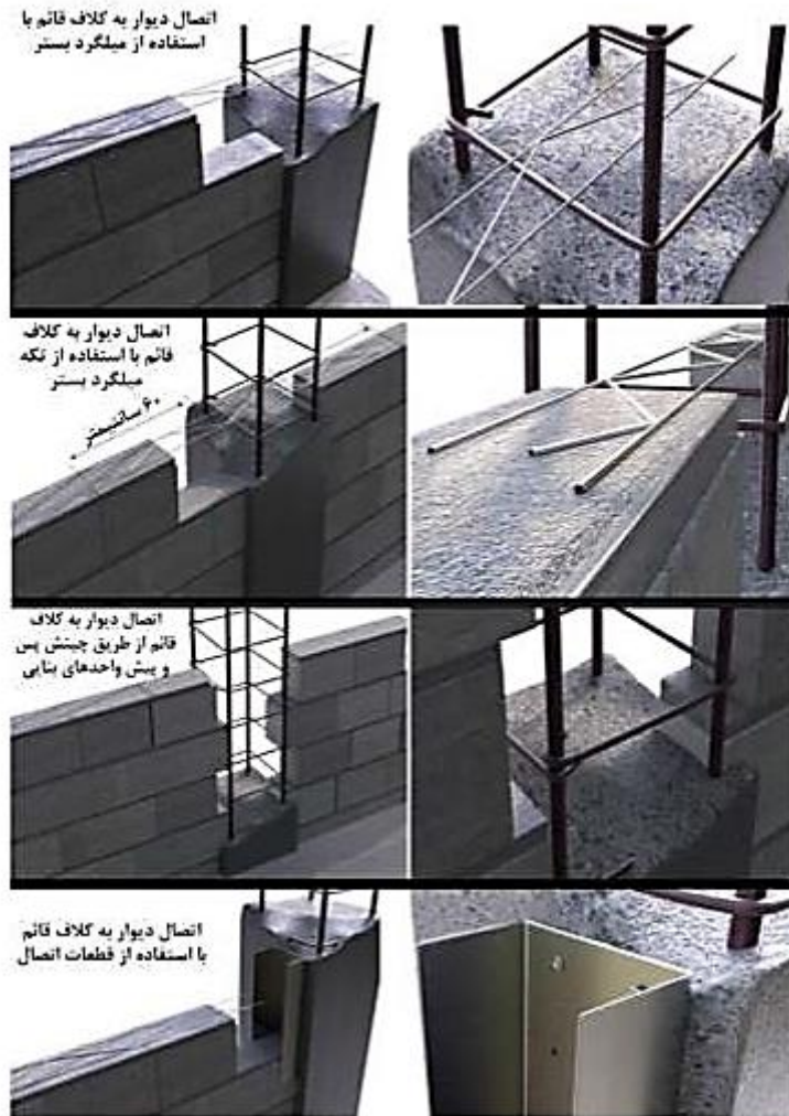
شکل ۱-۵ روش های اتصال دیوار به کلاف قائم بتنی (مورد آخر در خصوص کلاف فولادی نیز قابل استفاده است).
