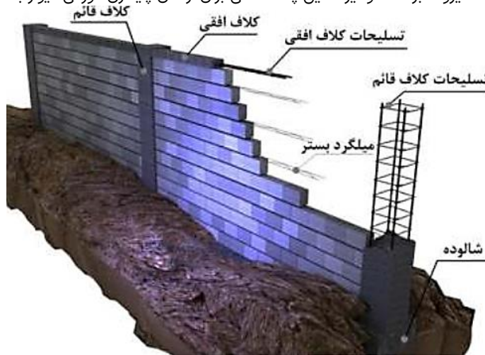
شکل ۱-۲ قسمت‌های اصلی دیوارهای محوطه بنایی
