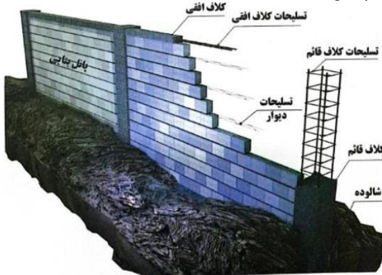
شکل ۱-۲ قسمت های اصلی دیوارهای محوطه بنایی
