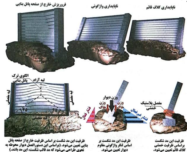
شکل ۲-۴ مدهای شکست دیوارهای محوطه
